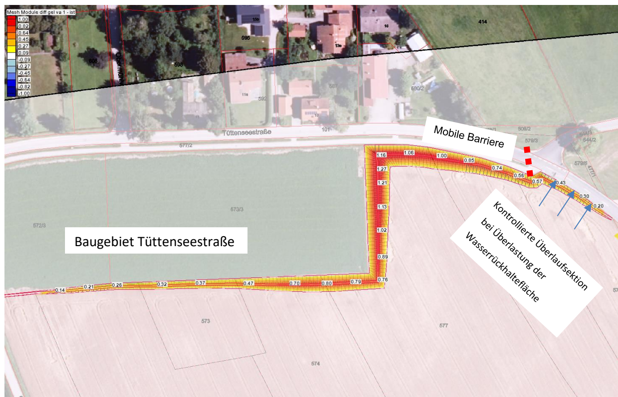
Abbildung 4.5: Wasserspiegelhöhen über Bestandsgelände entlang des geplanten Erdwalls
