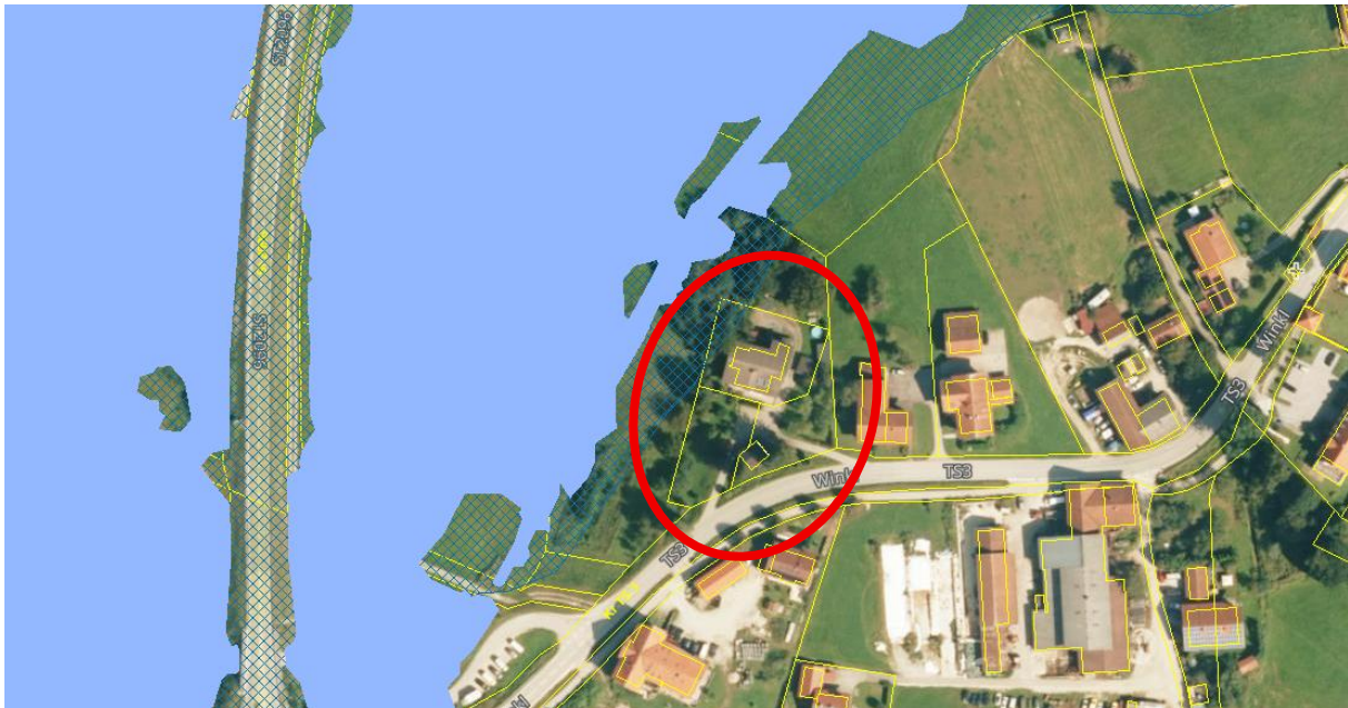
Abb. 5 Festgesetztes Überschwemmungsgebiet (blaue Schraffur) und Hochwassergefahrenfläche HQ100 (Blaue Füllfläche) mit Änderungsbereich 1 (rot – schematisch) – ohne Maßstab Quelle: BayernAtlas
